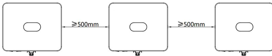
Fig. 4.5 Dimensioni di installazione degli inverter fianco a fianco
