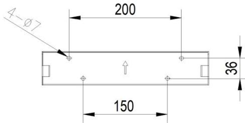
Abb. 4.7 Abmessungen Montagewinkel
