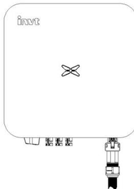
Abb. 5.9 Netzanschluss einphasiger Wechselrichter
