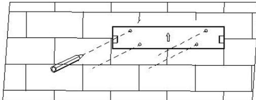
**Schritt 2:** Bohren Sie die Löcher zur Installation der Spreizdübel. Verwenden Sie M6×50 Spreizdübel aus Edelstahl.
