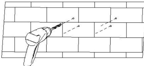
**Schritt 3:** Befestigen Sie die Installationshalterung. Reinigen Sie die Löcher und setzen Sie die Spreizdübel mit einem Gummihammer ein. Ziehen Sie die Mutter an, um das Ende des Bolzens zu fixieren. Entfernen Sie dann Mutter, Federscheibe und Unterlegscheibe, und befestigen Sie den Montagewinkel an der Wand. Sichern Sie mit einem Anzugsmoment von 13 Nm.
