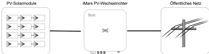
Abb. 2.1 Anwendung von netzgebundenen PV-Wechselrichtern
