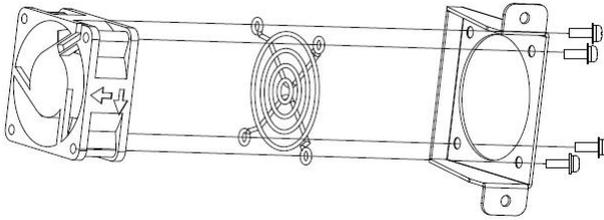
**Schritt 5:** Bauen Sie den Lüftereinsatz in umgekehrter Reihenfolge wieder in den Wechselrichter ein und starten Sie den Wechselrichter neu.
