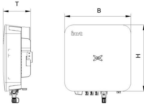
Abbildung 2.5 Abmessungen des Wechselrichters
