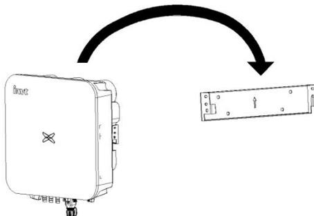
**Schritt 4:** Nachdem der Wechselrichter stabil in die Wandhalterung eingehängt ist, befestigen Sie die M4-Schrauben links und rechts am Gehäuse.
