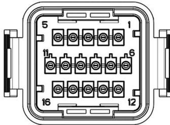
Abb. 5.7 DRM- und CT-Anschluss Vorderansicht
