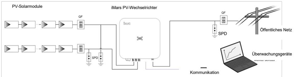
Abb. 5.1 Schematische Darstellung des Anschlusses eines netzgebundenen PV-Systems
