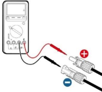
Abb. 5.4 Eingangsspannung messen
