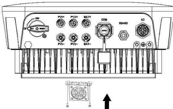
**Schritt 3:** Verwenden Sie eine weiche Bürste oder einen Staubsauger, um den Lüfter zu reinigen. Wenn der Lüfter beschädigt ist, folgen Sie Schritt 4.
