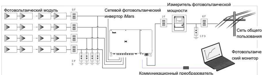
Рис 5.1 Схема подключения фотовольтаической системы к сети
