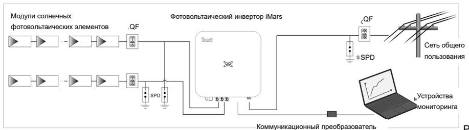
ис. 5.1 Схема подключения сетевой фотовольтаической системы электрогенерации
